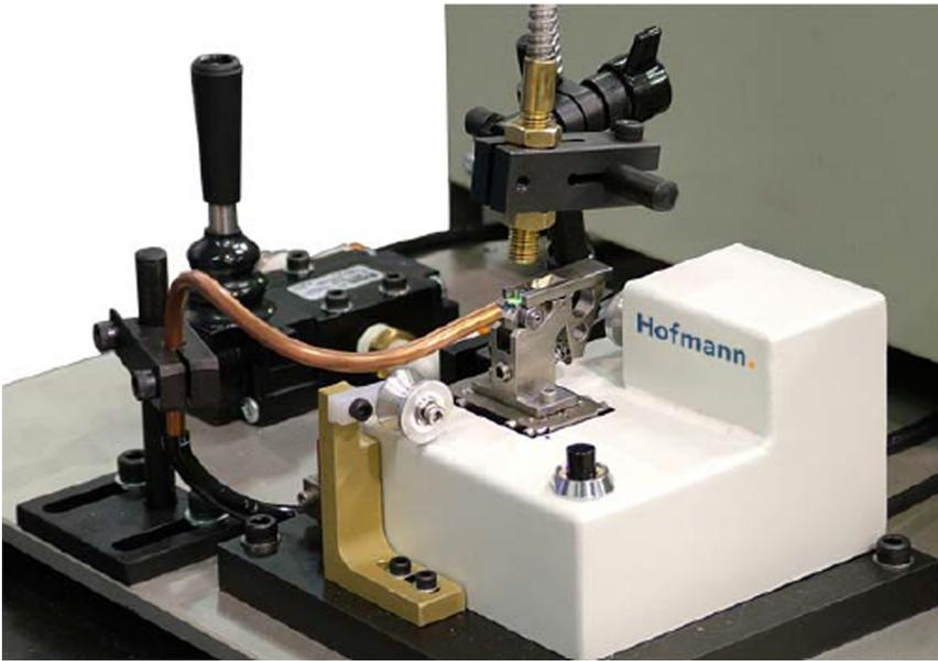
Maschine mit Druckluftantrieb und Aufnahmerahmen
